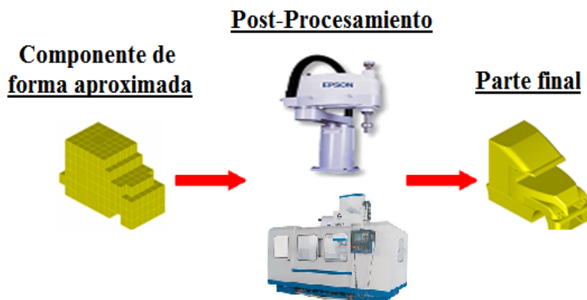
Figura 2. Esquema general del maquinado de modelos aproximados (octree).
