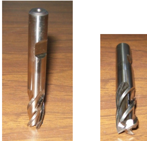
Figura 5.25. Herramientas de corte plana para desbaste, 10mm.
