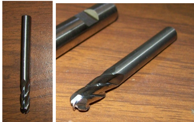
Figura 5.28. Herramienta de punta de bola para acabado, 6.35mm.
