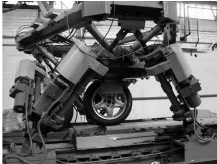
Fig. 3. El último prototipo de la plataforma de Gough usado en la compañía Dunlop Tires.
