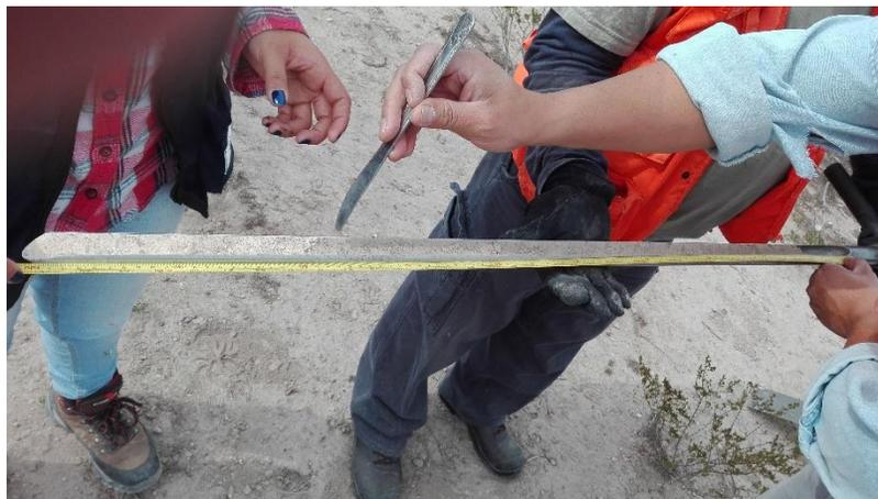
**Figura 20.** División de la muestra de suelo vertical en secciones.
