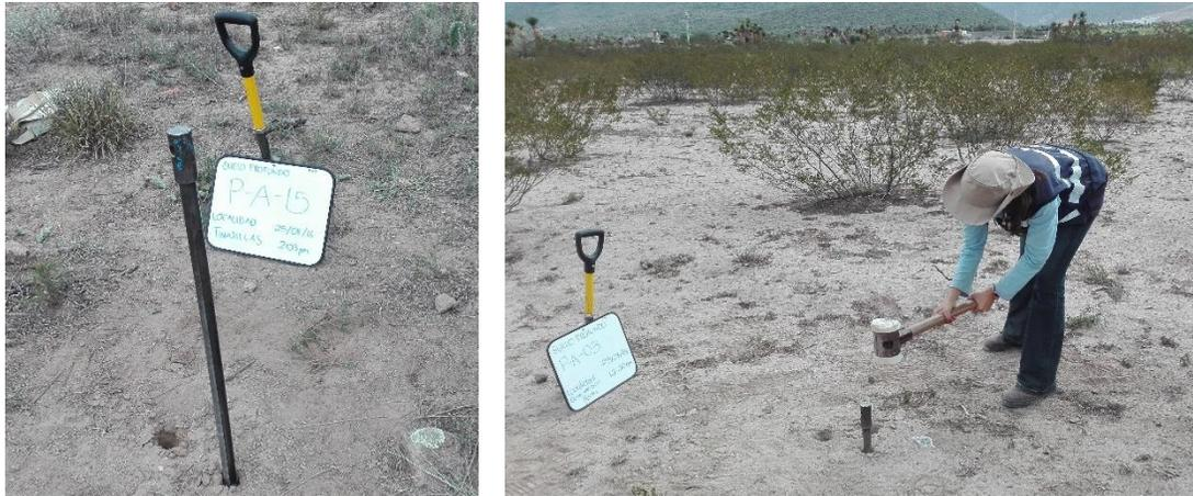
**Figura 19.** Obtención de la muestra de suelo vertical a 1 m de profundidad.
