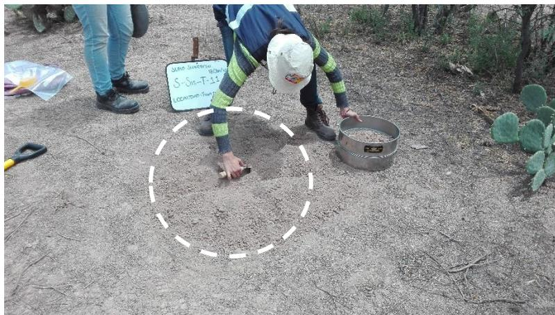
Figura 18. Homogenización, cuarteo, tamizado y colecta de muestra en campo.
