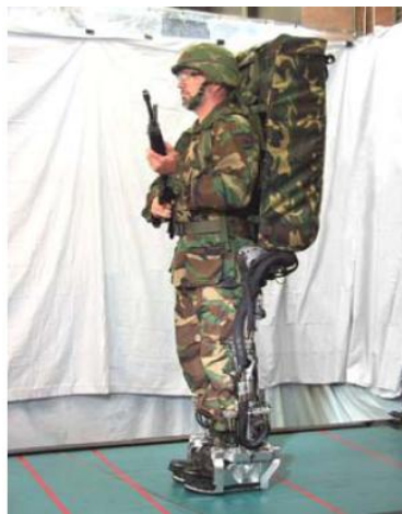
Figura 6. BLEEX, "exoesqueleto", fabricado por Kazerooni
