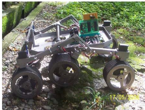
Figura 20. Robot móvil todo terreno RTT [32].
