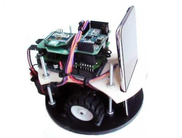
Figura 19. Robot móvil con iPod para transmisión de imágenes [31].
