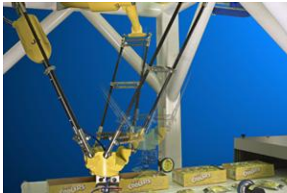
Figura 1. Robot paralelo en la industria alimenticia, M-3iA de FANUC.
