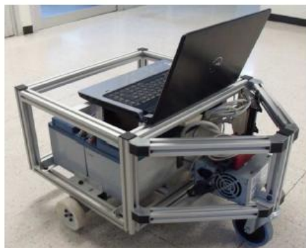
Figura 16. Robot móvil tipo unicycle. (Víctor Juárez [9])
