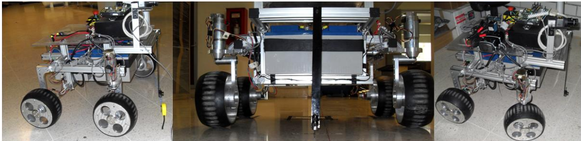
Figura 4.2. Configuración de dirección Ackerman robot CIEP_1
