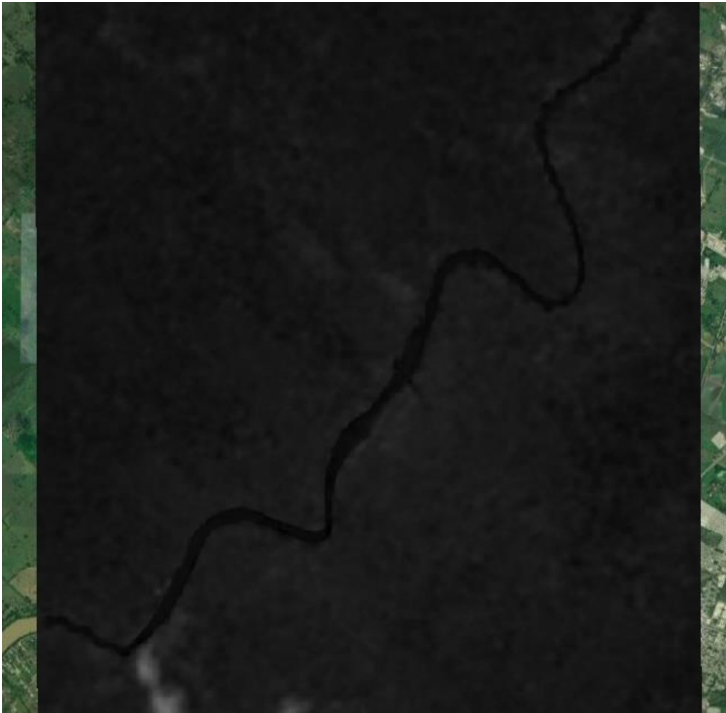
Figura 48. Modelo digital de elevación corregido, representa la topobatimetría de la zona de estudio.
