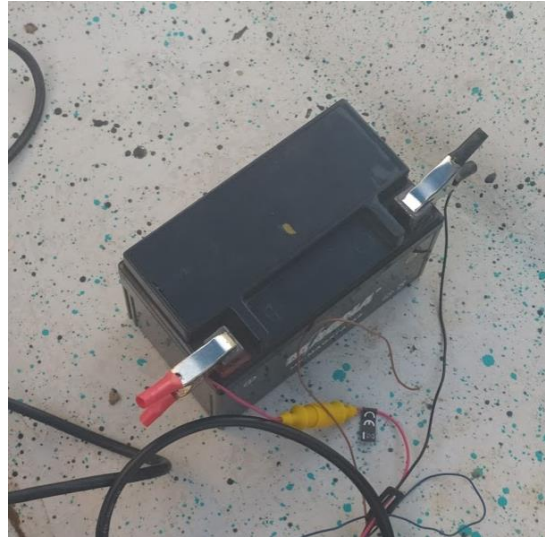
Figura 33. Batería de 12 volts utilizada para conectar la ecosonda.
