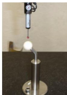
Figura 3.10 Calibración del palpador utilizando la esfera de calibración.
