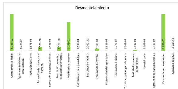
(c) Impacto de una planta de turbo gas durante su etapa de desmantelamiento.
