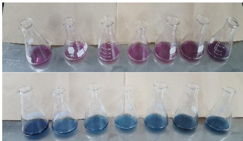
Figura 23. Determinación de dureza total con el método de titulación volumétrico.
