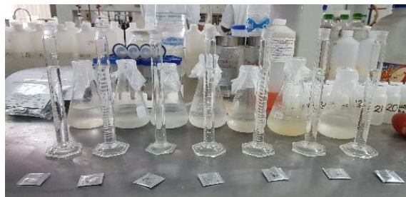
Figura 18. Determinación de \text{NO}_3^- con el uso de HACH/2000.
