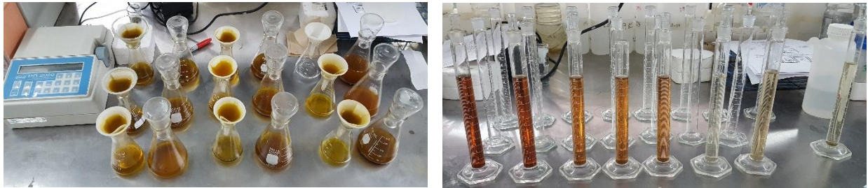
Figura 17. Determinación de materia orgánica con el uso de HACH/2000.
