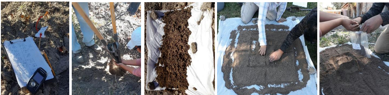
Figura 12. Ejemplo de recolección de muestra compuesta para un bloque de estudio.
