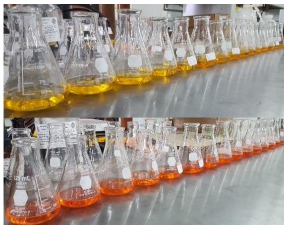
Figura 26. Determinación de \text{HCO}_3^- con el método de titulación volumétrica.
