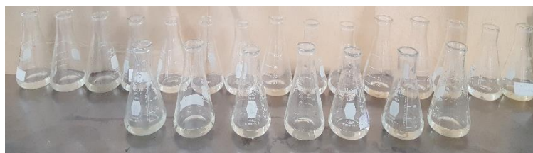
Figura 25. Determinación de \text{CO}_3^{2-} con el método de titulación volumétrica.
