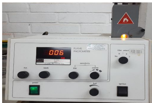
Figura 22. Espectrofotómetro de flama utilizado para la determinación de \text{Na}^+ y \text{K}^+ .
