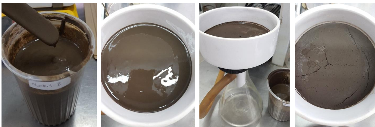
Figura 16. Ejemplo de la práctica: extracto de saturación para una muestra en estudio.
