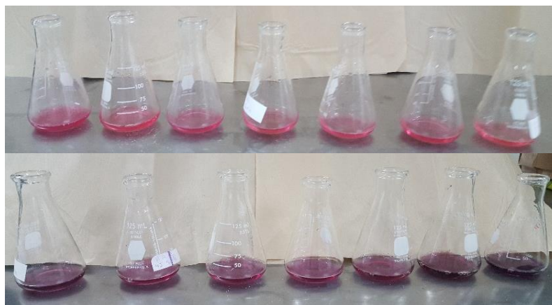
Figura 24. Determinación de \text{Ca}^{2+} con el método de titulación volumétrico.
