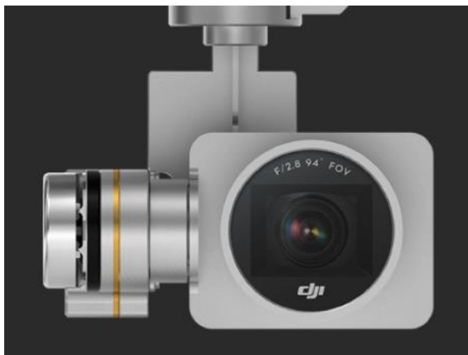
Figura 60. Sensor RGB 1/2.3 CMOS.
