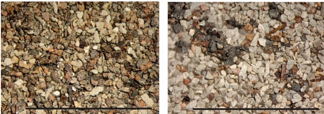
Figura 4.3. Material magnético de dos muestras donde se observan las láminas de intemperismo de material de acero y otras partículas magnéticas. Escala 1 cm.
