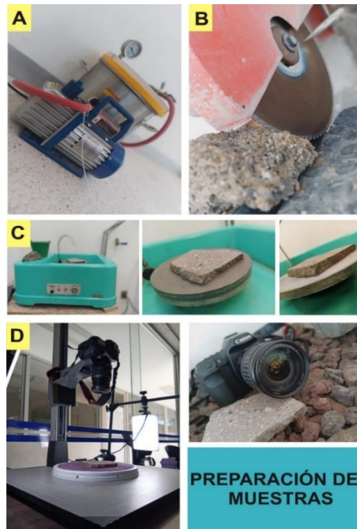
Figura 21. Metodología descrita para la preparación de muestras orientadas. A) Bomba y cámara de vacío para impregnación de muestras. B) Corte de muestras. C) Esmeril horizontal para pulir muestras. D) Mesa fotográfica con sistema de lámparas y cámara DSLR CANON de alta resolución (EOS 50D).
