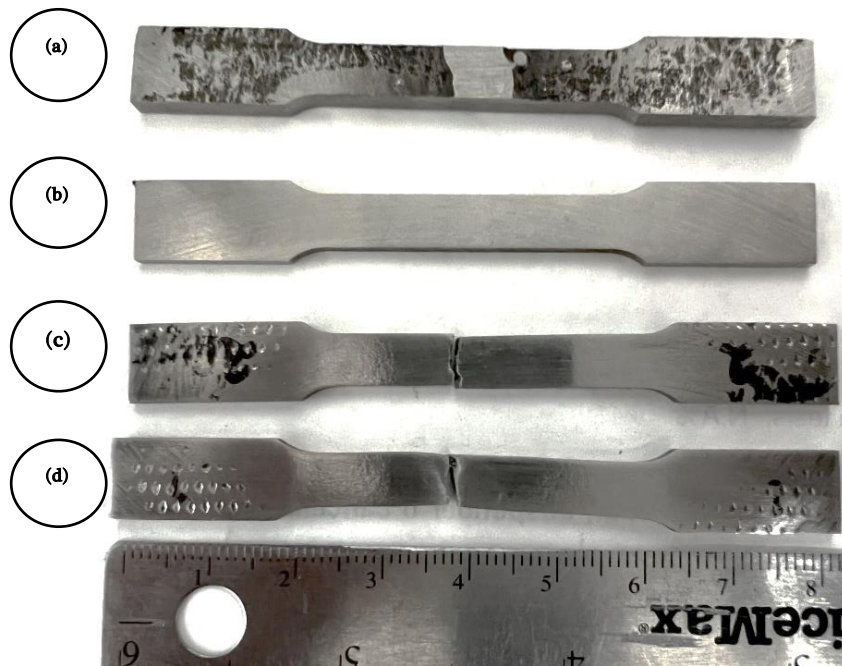
Figura 28. Probetas representativas de las uniones soldadas y de una geometría plana con base a la norma ASTM E8 [6], (a), (b) probetas antes del ensayo de tensión, (c) y (d) probetas después del ensayo de tensión.
