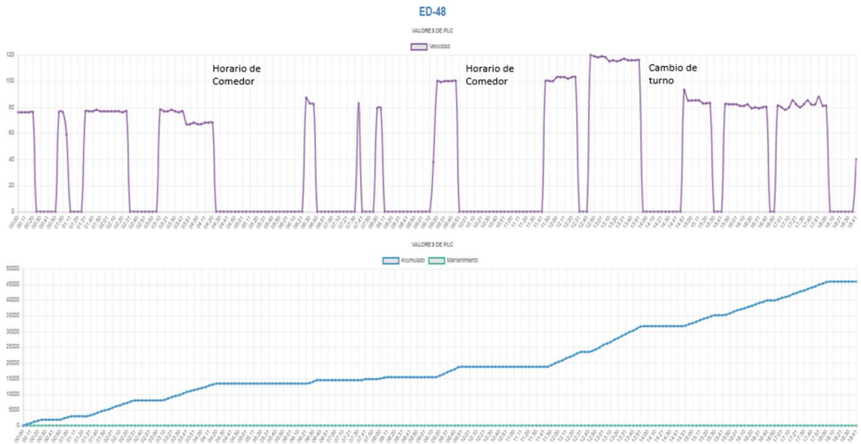
Ilustración 44. Gráfico de datos obtenidos por el PLC de máquina ED 48. Fuente: Elaboración propia.
