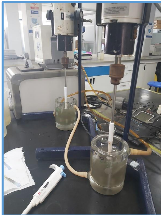
Figura 10. Sistema utilizado para la evaluación de desempeño de agentes orgánicos en la lixiviación ácida oxidativa de concentrado de cobre.
