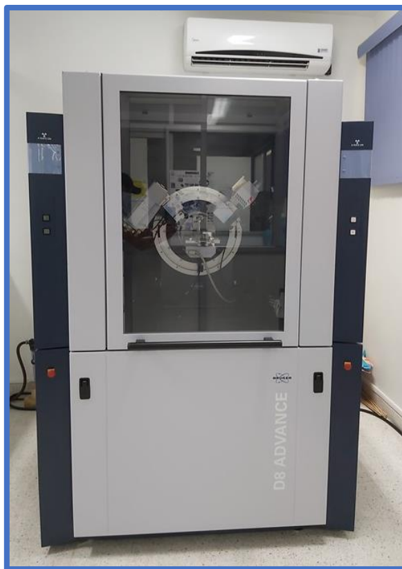
Figura 3. Equipo de Difracción de Rayos X Bruker modelo D8 Advance da Vinci.
