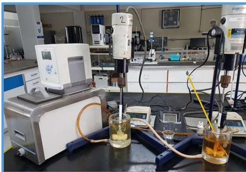
Figura 9. Sistema experimental utilizado para la evaluación de productos de lixiviación en la descomposición de H 2 O 2
