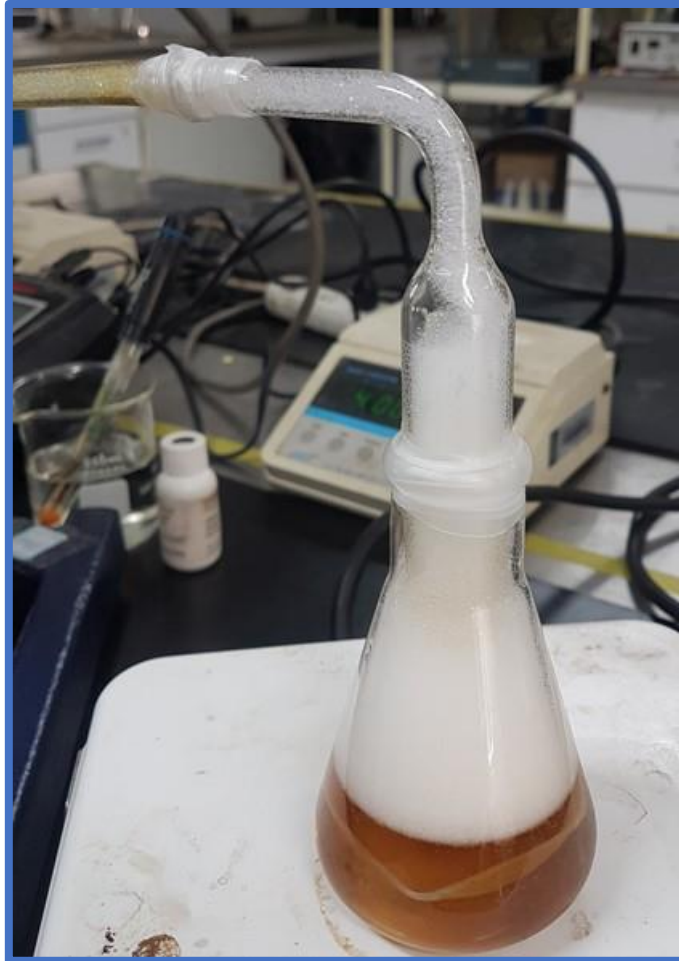
Figura 30. Formación de exceso de espuma a velocidades de agitación mayores de 150 rpm con polisorbatos Tween.
