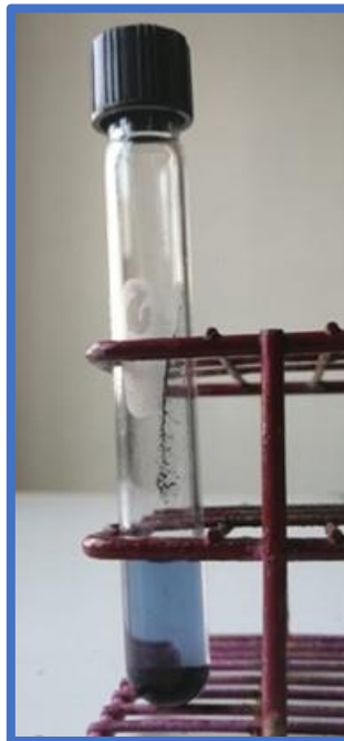
Figura 35. Tubo de ensaye con coloración azul formado de acuerdo al ensayo de Yodato-Yoduro para CHex, EG, T-80 y T-20.
