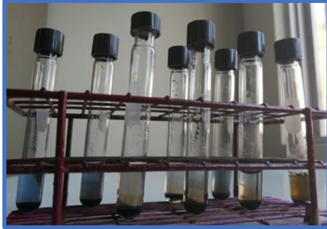
Figura 34. Tubos de ensaye para de detección de ácidos carboxílicos en soluciones de lixiviación con CHex, EG, T-80 y T-20 de izquierda a derecha.
