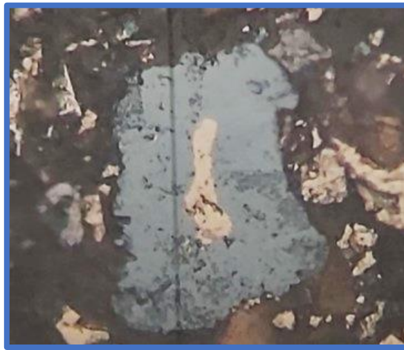
Figura 44. Observación en microscopio óptico de partícula de calcopirita (amarillo) asociada con covelita (color azul), 20X.
