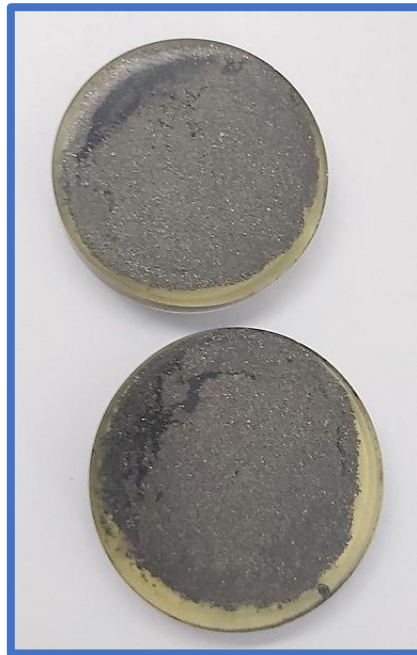
Figura 5. Probetas de resina epóxica transparente con concentrado de cobre.
