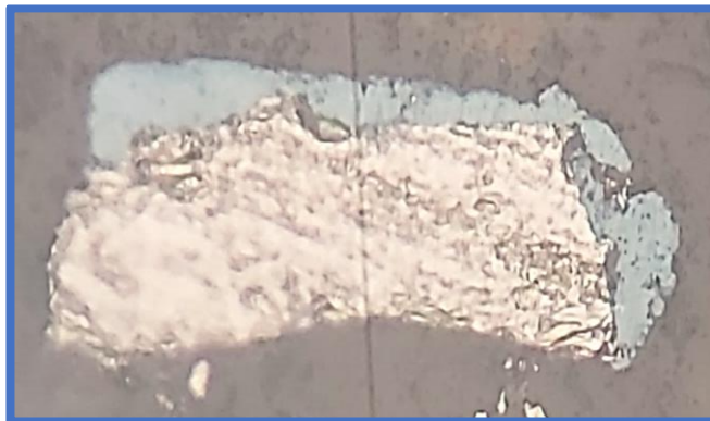
Figura 49. Observación en microscopio óptico de partícula de pirita (amarillo claro) asociada con covelita (azul), 20X.
