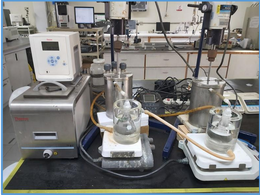
Figura 11. Sistema experimental empleado en pruebas de mineralización de agentes orgánicos.
