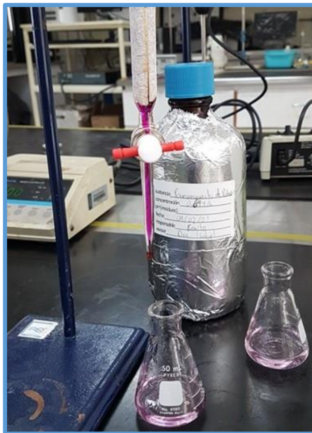
Figura 8. Proceso de valoración de \text{H}_2\text{O}_2 por medio de titulación volumétrica.
