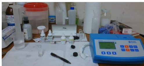
Fig.11 Fotometro Hanna HI 83225 y reactivos para determinación de \text{NH}_4^{++} y \text{PO}_4^{3-} .
