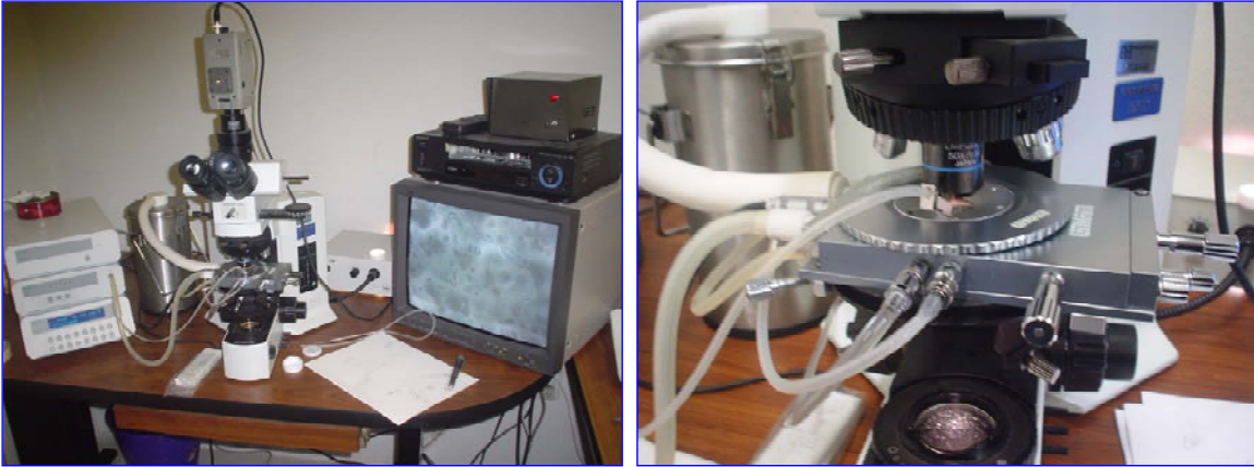
Figura IV.10. Equipo microtermométrico con platina calentadora-refrigeradora Linkam, consola de controles, microscopio Olympus con duplicador de aumentos, deposito de nitrógeno líquido, sistema de video (Centro de Geociencias, UNAM.)
