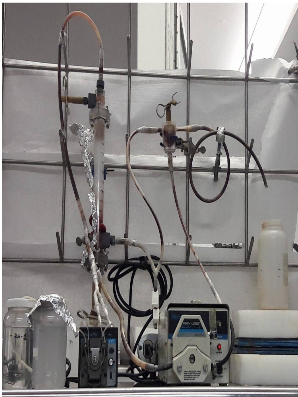
Figura A. Fotografía del aspecto visual del reactor de lecho fluidificado inverso para la recuperación de nanopartículas de ZnS.
