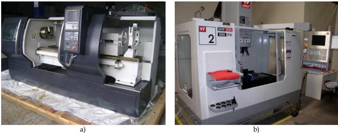
Figura 1.8. Ejemplos de máquinas CNC: a) torno y b) fresadora.
