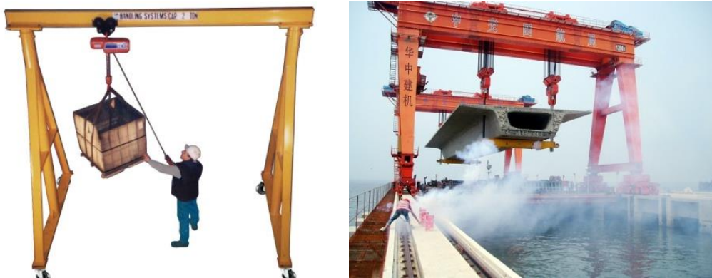
Figura 1.12. Aplicaciones de grúas Gantry en distintos campos de trabajo.
