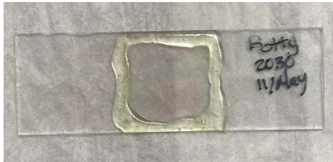
Figura 4.3 Muestra final para prueba de tensión
