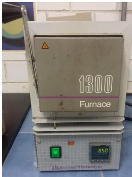
Figura II-6. Horno mufla marca Thermolyne 1300 utilizada para realizar los tratamientos térmicos.
