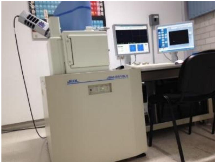
*Figura II-9. Microscopio electrónico de barrido marca JEOL modelo JSM-6610LV.*
