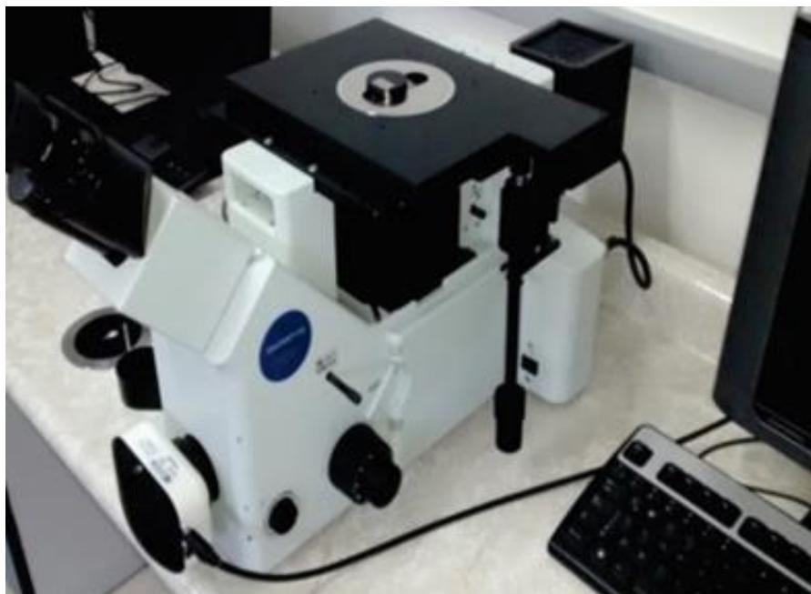
*Figura II-10. Microscopio Olympus GX51.*
