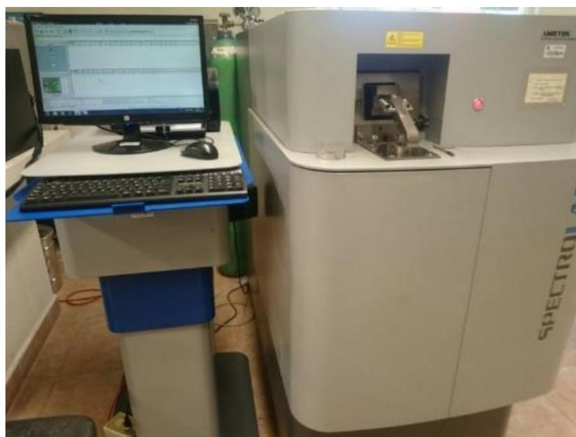
Figura II-8. Espectrofotómetro de emisión óptica por chispa marca Spectro modelo LabS.
