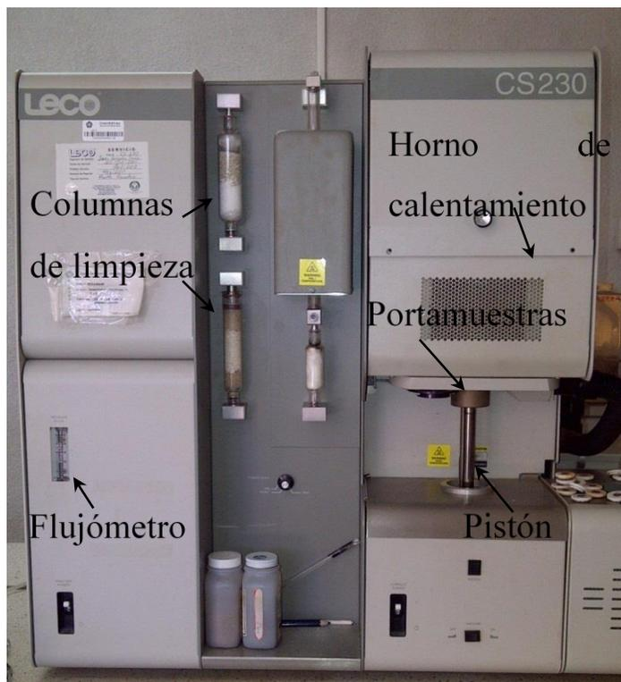
Figura II-7. Determinador simultáneo de C y S marca Leco modelo CS 230.
