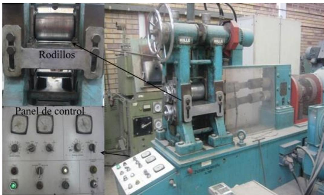
Figura II-5. Molino de laboratorio HILLE Helicon MK4 utilizado para la deformación en frío de las muestras.
