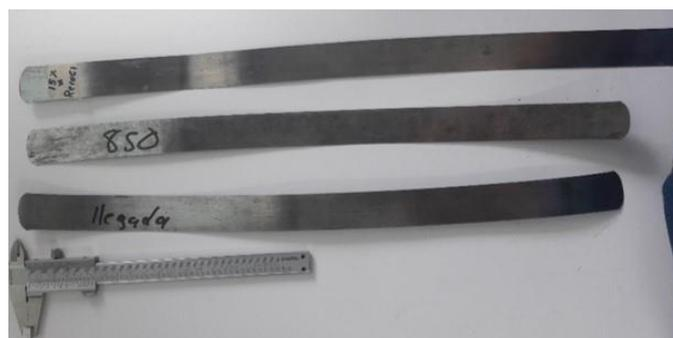
Figura II-4. Muestras obtenidas después del proceso de laminación en frío.
