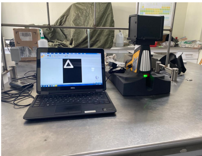
Figura 30. Fotografía del equipo XRF portátil DELTA Professional, determinación de concentraciones totales
