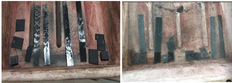
Figura 3.7. Decapado del material con ácido clorhídrico al 20%.
