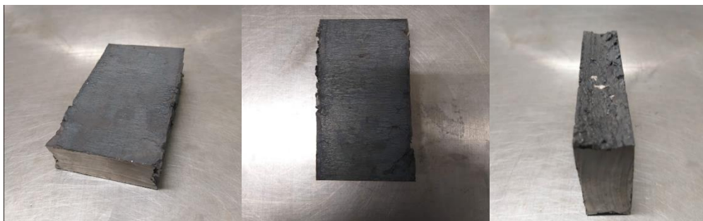
Figura 2.2. Lingote de acero medio manganeso.
