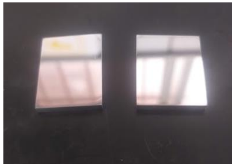
Figura 2.5. Muestras para DRX, MO, MEB y microdureza.
