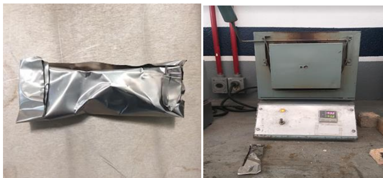
Figura 3.6. Tratamiento intercrítico del acero medio manganeso.
