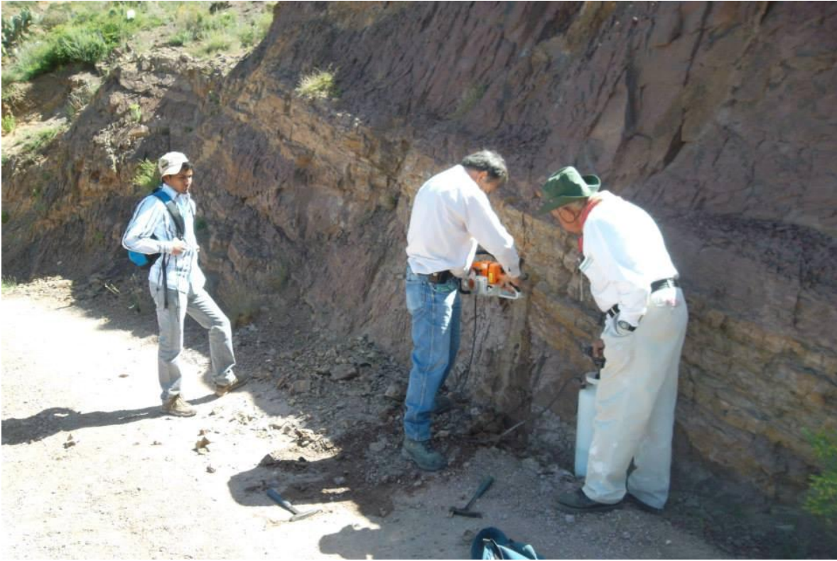
Figura 3.- toma de muestra palinológica con ayuda de una perforadora de diamante.
