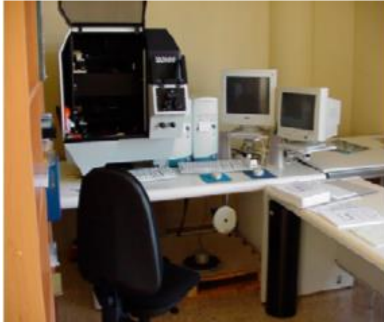
Figura 3.3. Restituidor analógico con sistemas computacionales (Quirós Rosado, 2014).
