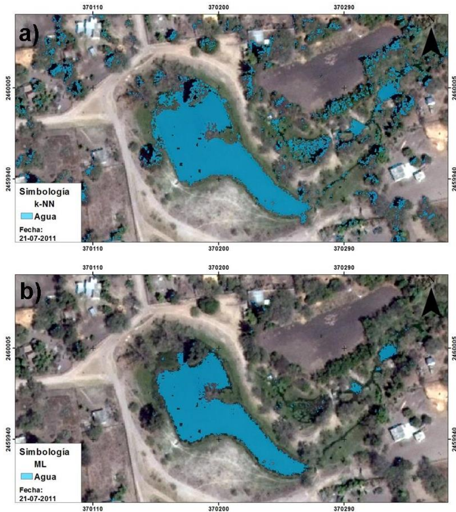
Figura 16. Resultados de clasificación de los algoritmos a) kNN y b) ML solo para la clase agua.
