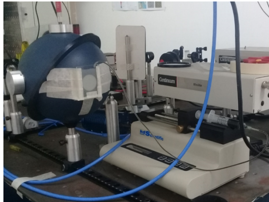
Figura 5.10. Arreglo experimental para la medición del coeficiente de absorción variable en el tiempo.
