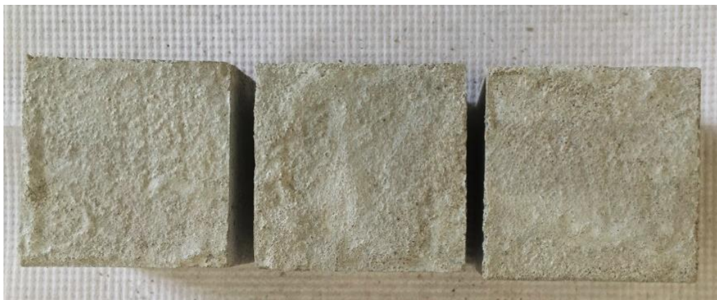
Figura 2.4. Aspecto de los morteros base cemento después de 28 días de curado.
