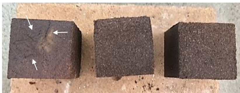
Figura 3.7. Morteros MP0 después de un tiempo de exposición de 3 h a 300 °C.
