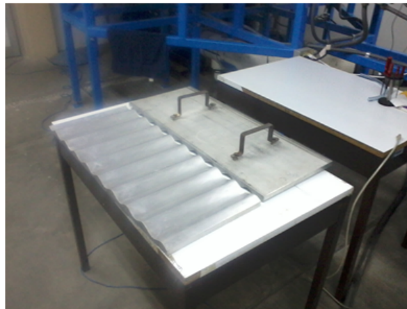
Figura 2.10: Moldes de aluminio con superficie senoidal utilizados por Oviedo et al [18].
