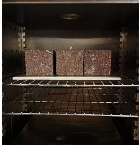
Figura 10. Imagen del pre tratamiento térmico de las muestras antes del proceso de inducción de sales.
