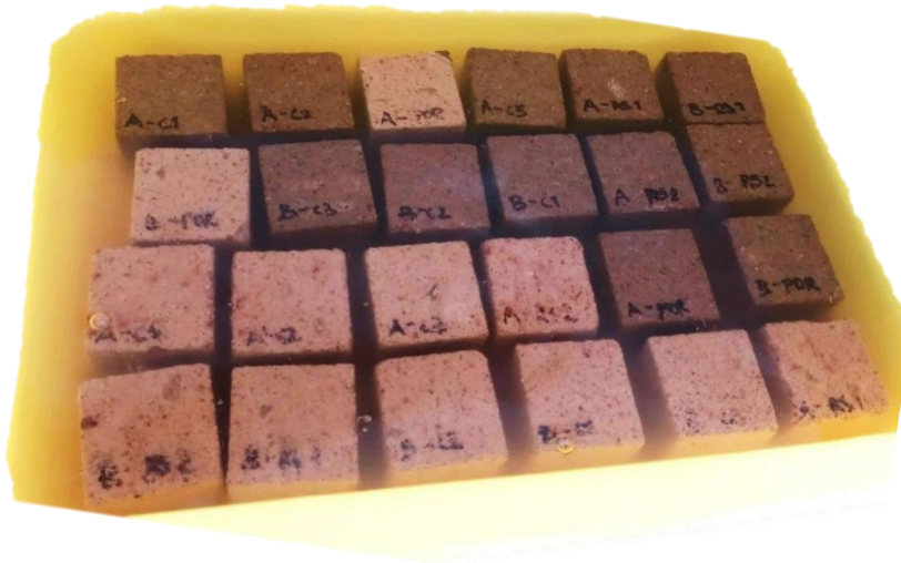
Figura 20. Muestras en inmersión de sulfato de sodio decahidratado.
