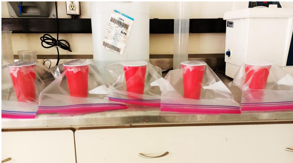
Figura 22. Probetas colocadas en recipientes desechables para su consolidación por inmersión.
