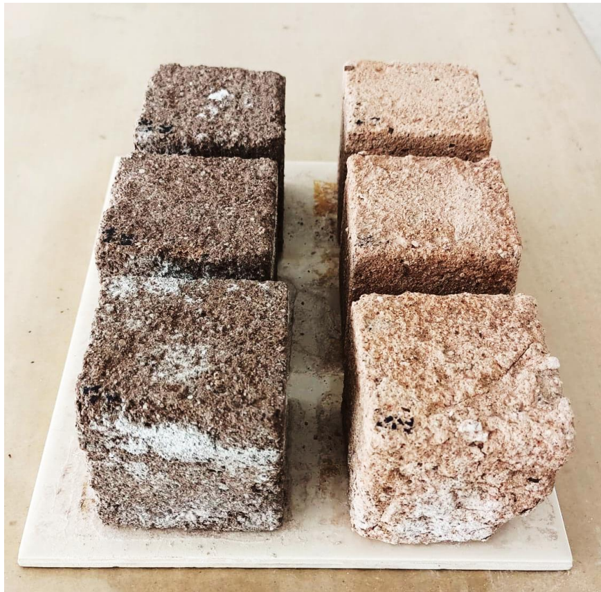
Figura 47. Imagen de las muestras después de 5 ciclos por la cantera blanca y 5 ciclos de la café.
