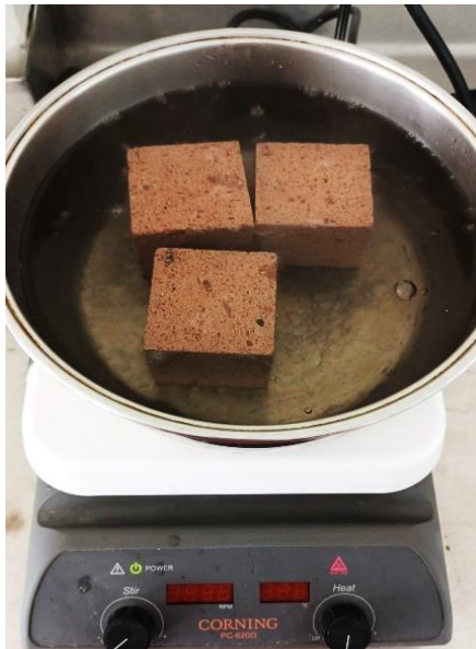
Figura 8. Probetas en inmersión en agua hirviendo para determinar la porosidad.
