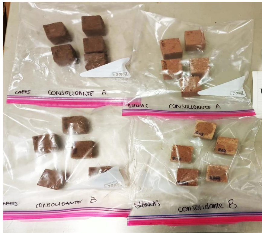
Figura 23. Probetas posteriores a la consolidación empaquetadas herméticamente.
