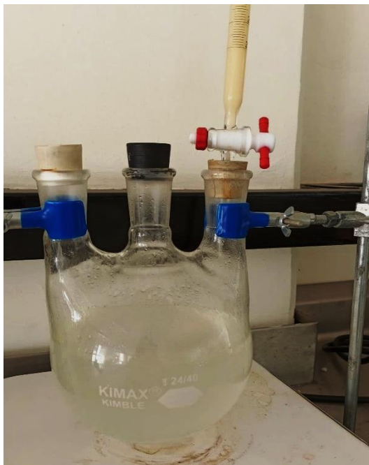
Figura 16. Goteo de nanopartículas de sílice a la formulación del consolidante NANO-TS.
