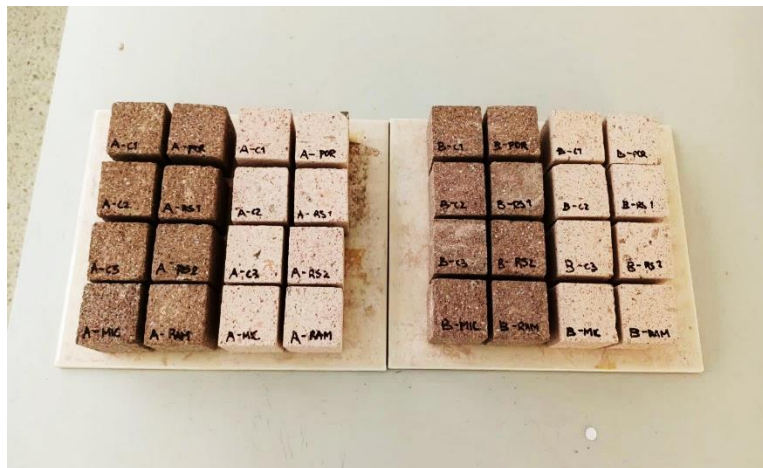
Figura 5. Probetas de los dos tipos de toba volcánica empleadas en la investigación.
