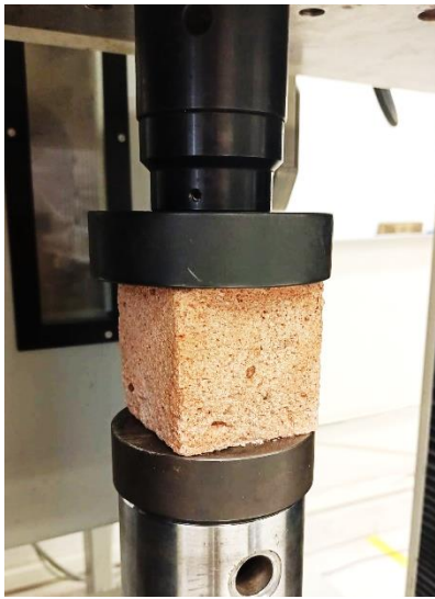
Figura 9. Prueba de compresión para probeta de toba blanca.
