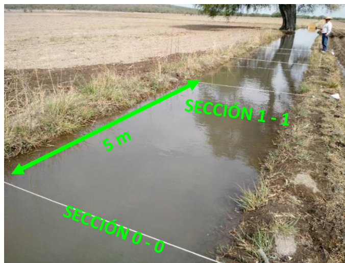
Figura 29 Medición de la velocidad de escorrentía sobre el perfil del canal secundario
