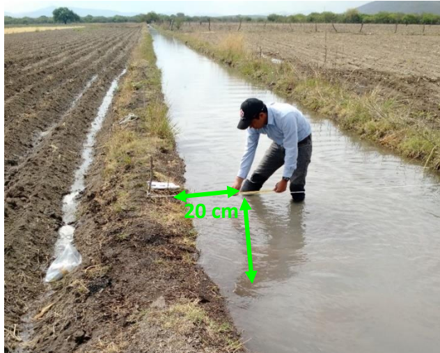
Figura 30 Obtención de la sección del canal secundario
