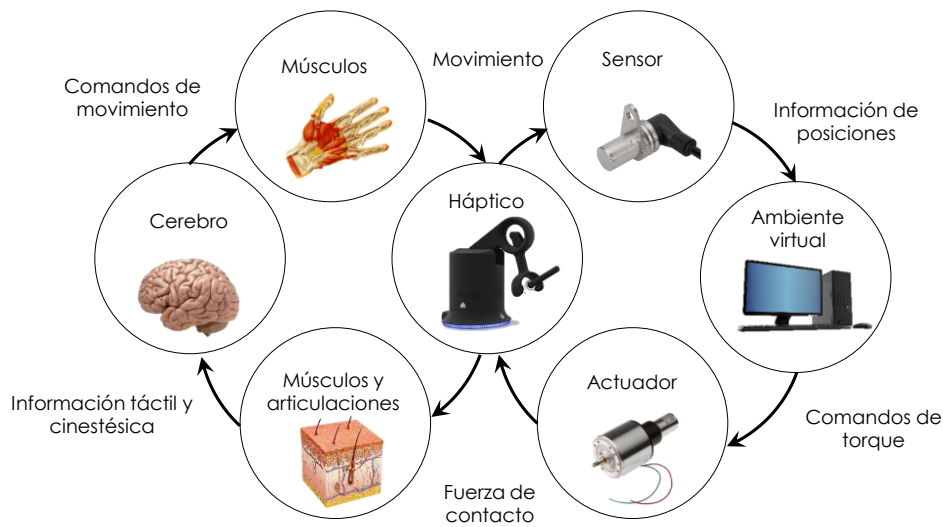
Figura 1.3 Secuencia de funcionamiento de un dispositivo háptico.
