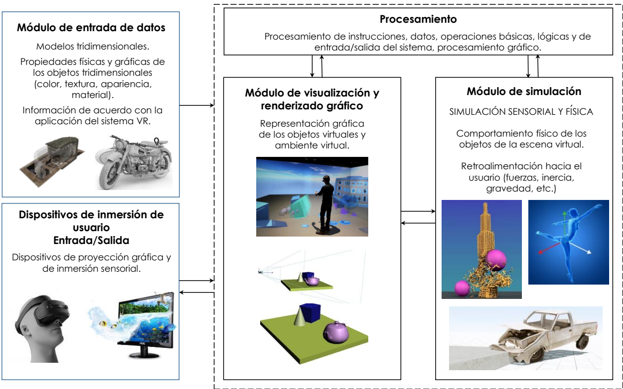
Figura 1.1 Arquitectura general de un sistema de realidad virtual.
