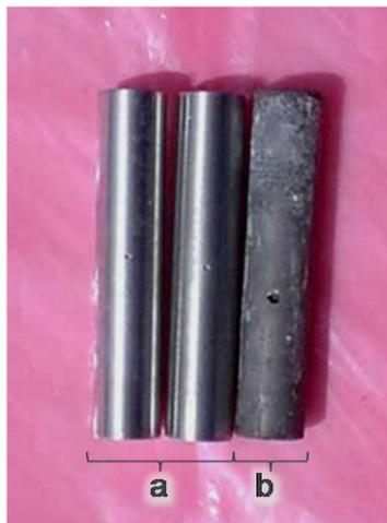
Figura 2.4. Aspecto de los ánodos de las aleaciones Zn-22%Al-x%Ag, a) sin ensayar, b) ensayado en la solución de NaCl 0,5 M. Obsérvese la porosidad en ambos estados.
