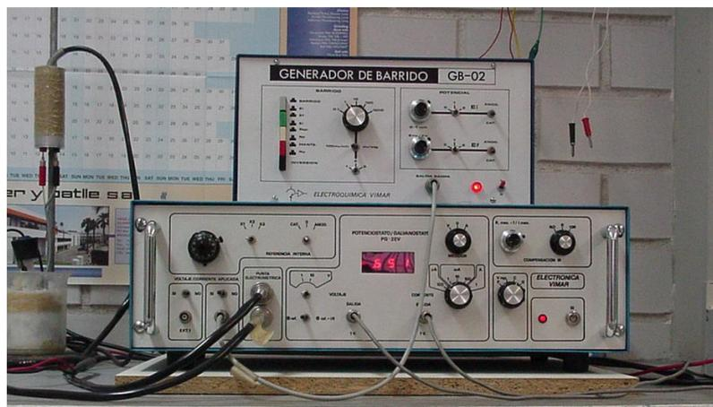
Figura 2.8. Potenciostato/Galvanostato Vimar modelo PG-2EV (parte inferior) y generador de espectro de voltaje Vimar modelo GB 02 (parte superior).
