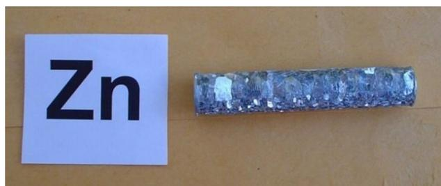
Figura 2.5. Aspecto del cilindro de Zn SHG después del decapado.
