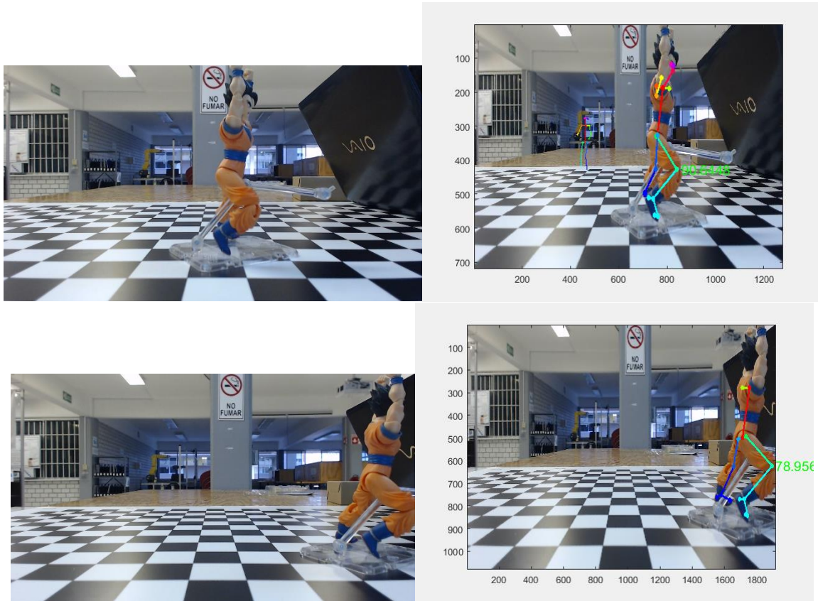
Figura 4. 17. Mala detección del ángulo de rodilla debido a la distorsión de lente. Las imágenes de arriba muestran un ángulo de aproximadamente 90° cuando las de abajo muestran un ángulo de aproximadamente 79 grados. La figura mantuvo la misma posición.
