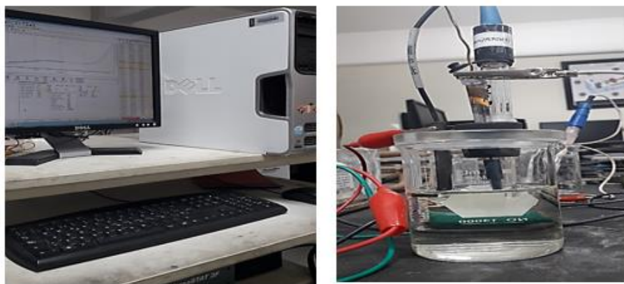
Figura 76: Sistema de tres electrodos conectado al potenciostato VersaSTAT 3F empleado para el análisis voltamperométrico.
