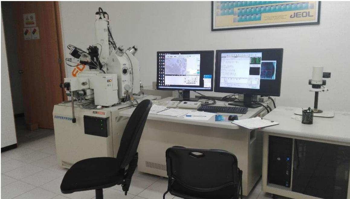
**Figura 2.** Fotografía del equipo de Microsonda Electrónica de Barrido (EPMA) modelo JEOL JXA-8900R del Instituto de Geofísica de la UNAM (Campus Morelia).
