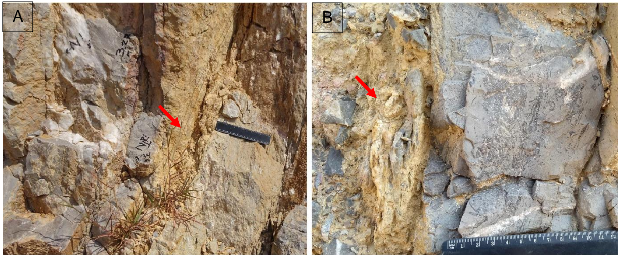
Fig3.2.42. A y B. Horizontes de material tipo “chalk” dispuestos entre caliza de espesor decimétrico (flechas rojas).
