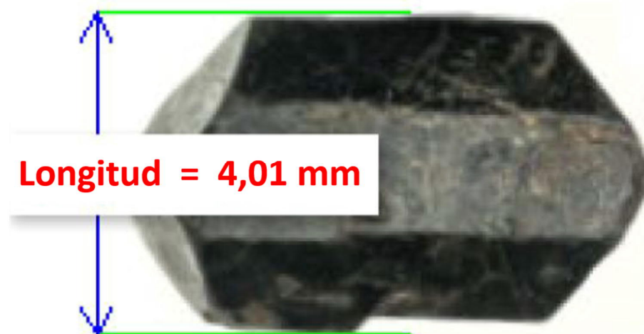
Figura 33. Ejemplo de medición de longitud de un grano (Guía de usuario Nikon NIS-Elements AR)
