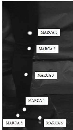
Figura 2.15. Definición de las marcas colocadas en la pierna.
