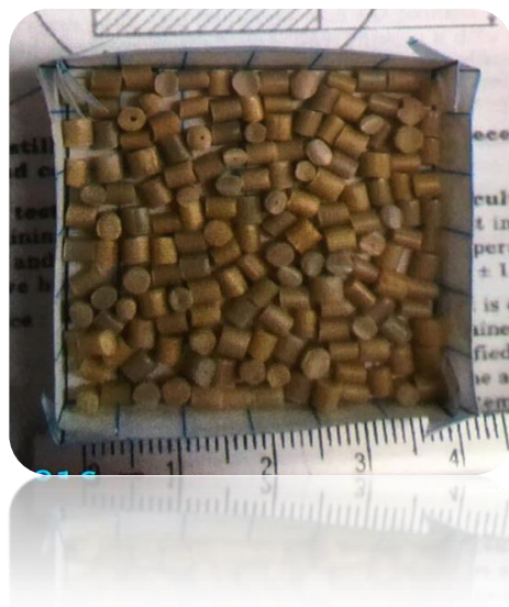
Figura 12. Pellets impregnados de Nps de plata y zinc para la evaluación del crecimiento microbiano (Sánchez, 2017)
