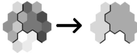
Figura 2.16 Esquema para el *Clean Up Grain CI Standardization* [10].
