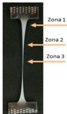
Figura 4.4 Zonas de la probeta de zinalco donde se analizará la microestructura.
