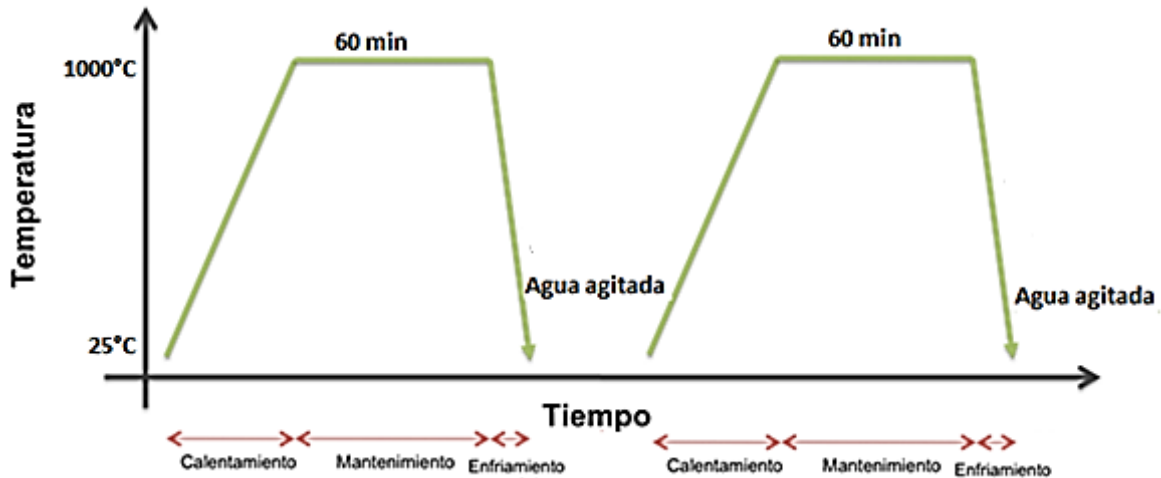
Figura 13. Esquema del ciclo térmico empleado para simular condiciones de fatiga térmica.
