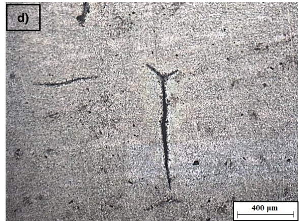
Figura 42. a) y b) Histograma y tabla de datos que muestra la frecuencia de la distribución de la medida de las grietas para ambos aceros, c) y d) micrografías del acero HT y del acero austenítico modificado con Nb con 100 ciclos térmicos y magnificación de 5X.
