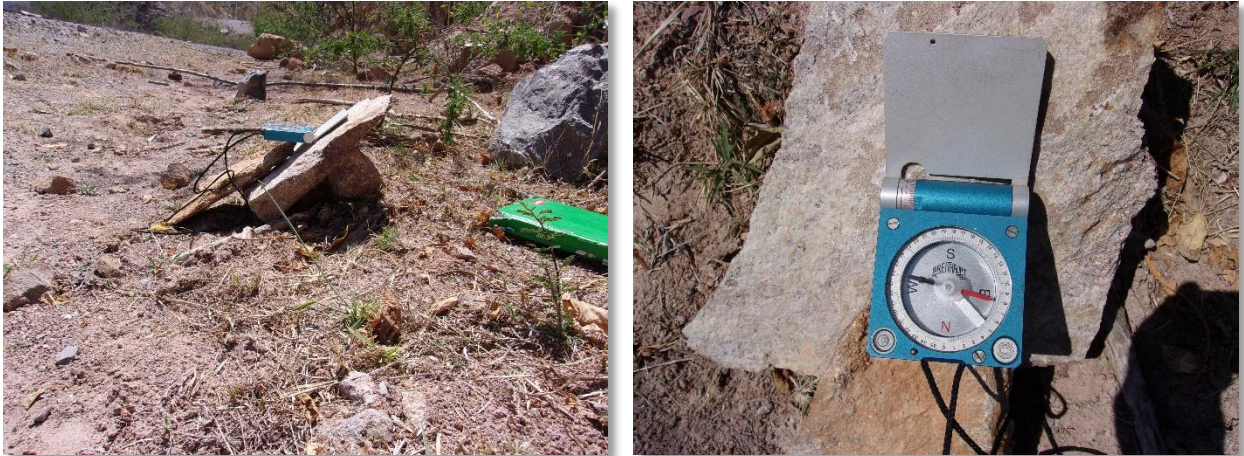
Figura 38.- Tilt Test realizado en campo en un bloque de la ignimbrita el órgano donde el ángulo obtenido es de 30^\circ en condición seca.
