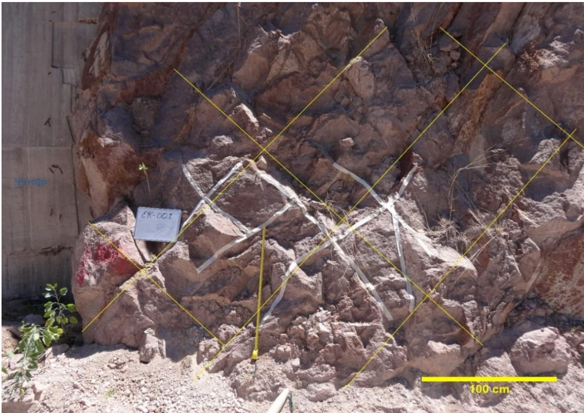
Figura 12.- Imagen escalada de talud estación sobre la ignimbrita el órgano mostrando las direcciones de las familias principales.
