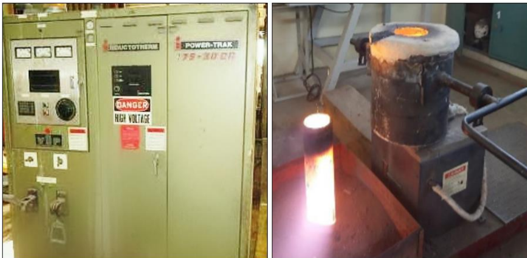
Figura 15. Horno de inducción Power-Trak 35-96.
