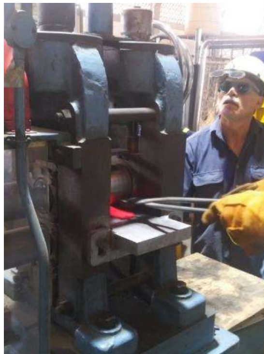
Figura 18. Deformación plástica del acero a altas temperaturas.
