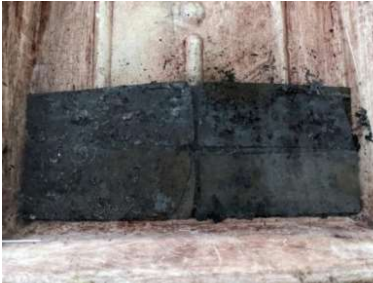
Figura 32. Láminas que muestran el óxido formado durante los tratamientos térmicos.
