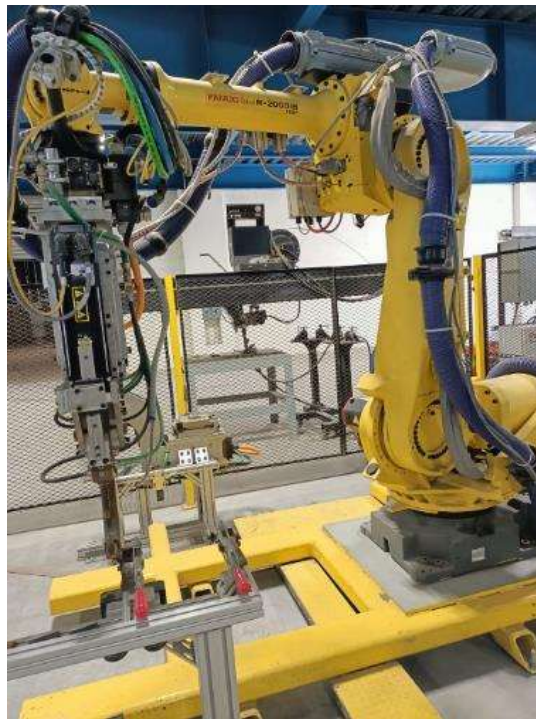
Figura 34. Robot FANUC Robot R-2000 iB utilizado para realizar las uniones de AHSS mediante el proceso RSW.
