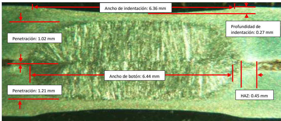
Figura 62. Mediciones realizadas en el botón de soldadura número 7.
