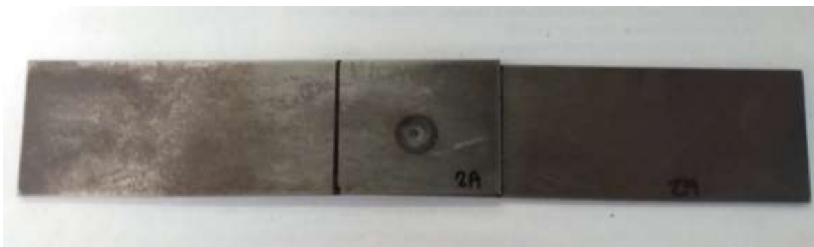
Figura 83. Muestra a traslape unida por el proceso RSW para realizar el ensayo de tensión por corte.
