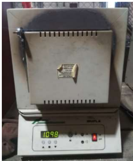
Figura 14. Mufla marca Felisa empleada para el recalentamiento de los lingotes.
