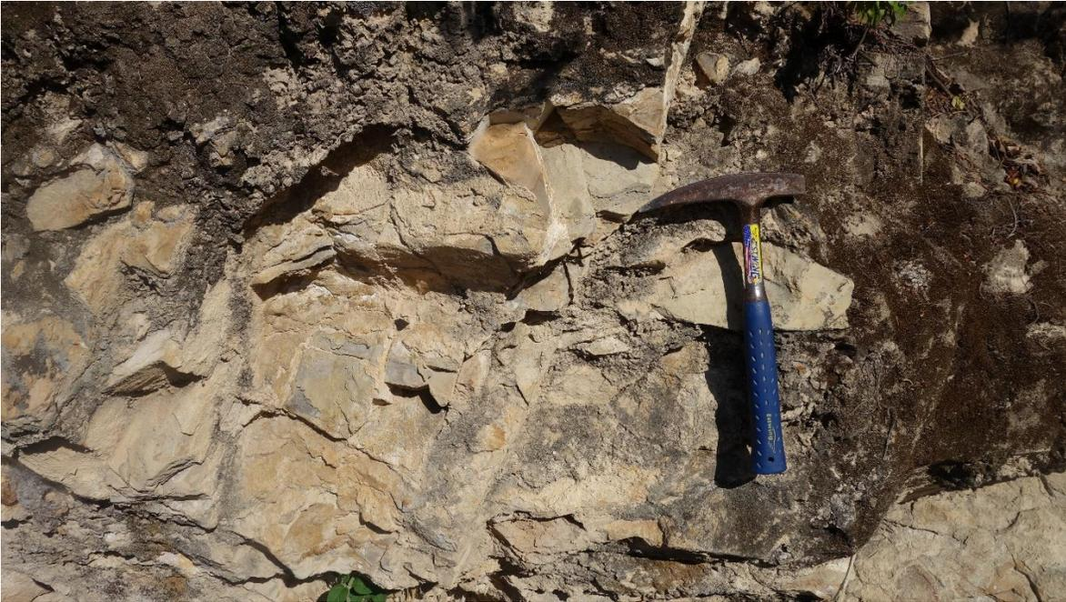
Figura 14. Afloramiento de arenisca de grano medio-fino con finas capas de limolita intercaladas.
