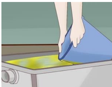
Figura 30. Limpieza de trampa de grasas y aceites.
