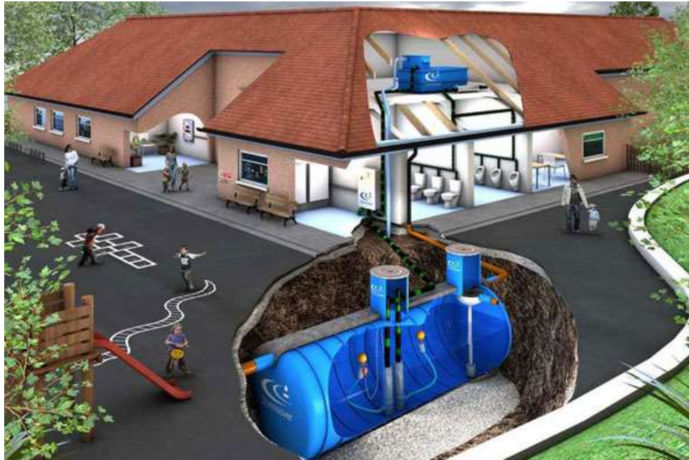
Figura 3-6 - Captación de agua de lluvia para una instalación educativa, imagen de Stormsaver
