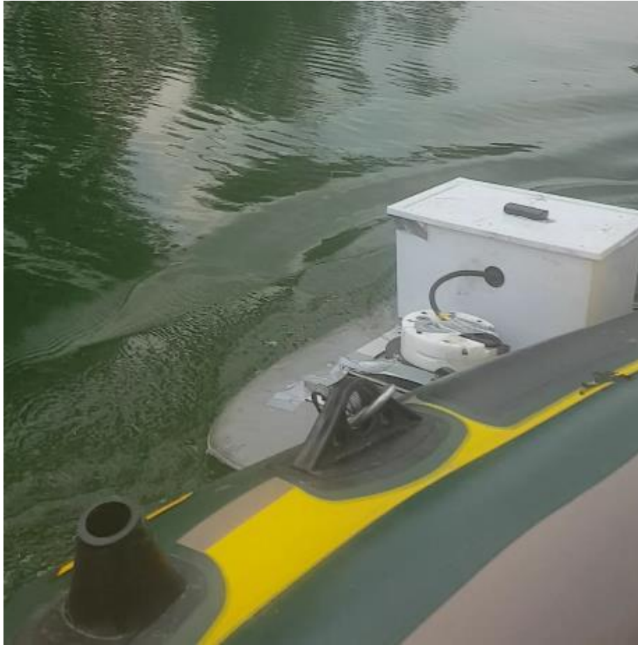
Figura 3.30.- Vista frontal de hydroboard durante navegación de batimetría.
