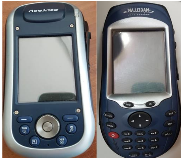
Figura 4.14.- Equipos GPS Ashtech Mobile Mapper 100" y "Thales Magellan Promark 3".
