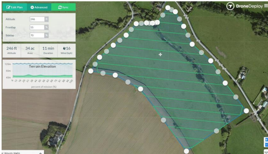
Figura 4.4.- Interfaz del software DroneDeploy. (Berardi, 2016)
