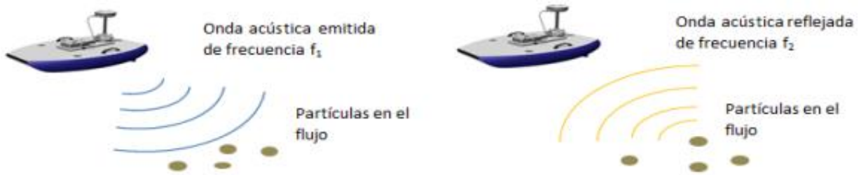
Figura 0.2.- Esquema del funcionamiento del ADCP. (Díaz Lozada, Caminal, Barchiesi, Herrero, & García, 2014)
