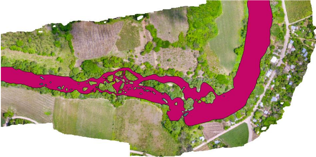
Figura 4.31.- Vista de SIG con el polígono de la superficie del agua delimitado con la ortofoto.
