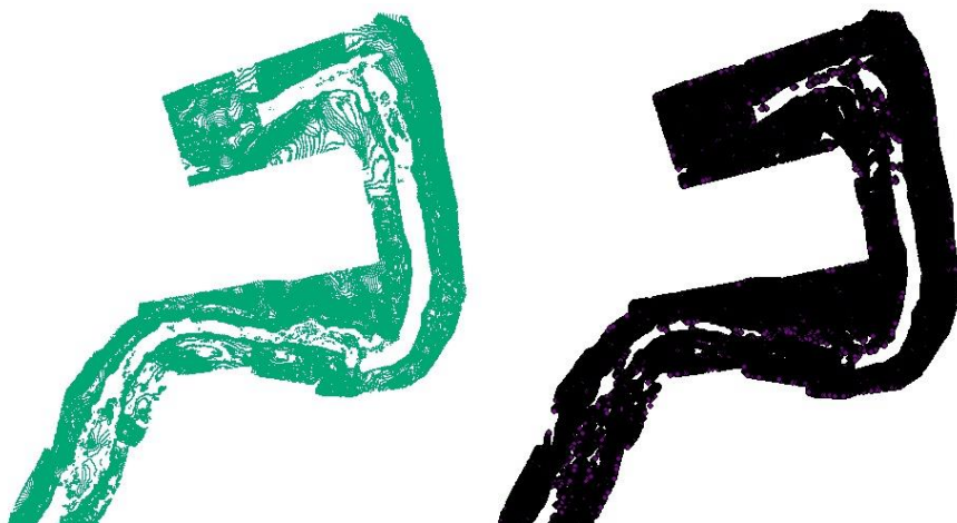
Figura 4.34.- MDE de la superficie del terreno convertido a polilíneas y a puntos.
