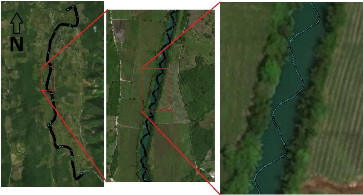
Figura 4.22.- Medición de batimetría en zigzag.
