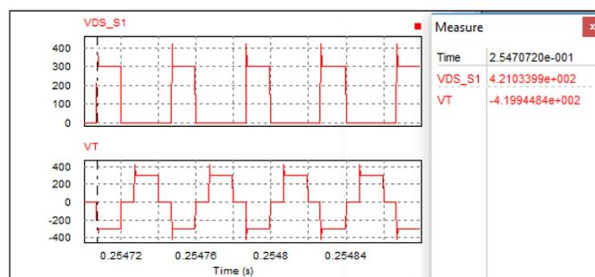
Figura 2.12. Tensiones  $V_{DS_{S_1}}$  y  $V_T$  del *CEPCA* para una fuente de *CD* en la entrada.
