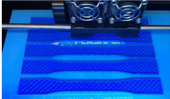
Figura 3.4. Ángulo de relleno de \pm 45^\circ y orientación plana de las probetas.
