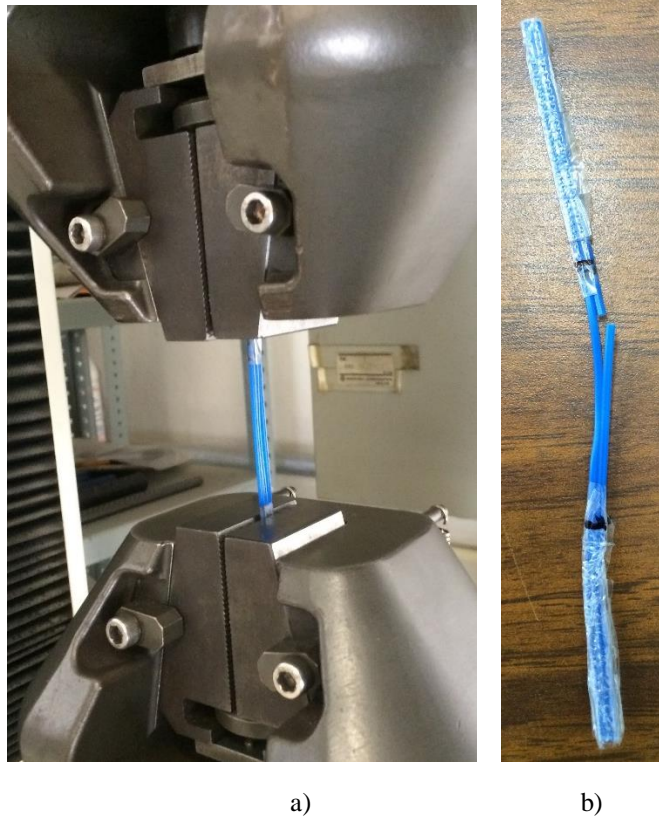
Figura 3.9. Tramos de filamentos de materia prima: a) Filamentos durante ensayo a tracción y b) Filamentos al terminar el ensayo.
